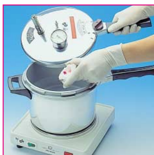
Introducir el modelo en el Polyclav® para su endurecimiento
